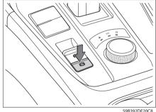
При движении на склоне, остановке перед красным сигналом светофора и движении с частыми остановками, функция автоматического удержания автомобиля (AVH) позволяет водителю не удерживать педаль тормоза длительное время и не активировать стояночный тормоз раз за разом. Она
