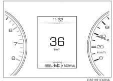
Когда выключатель зажигания находится в режиме ON. на информационном дисплее отображается информация о текущей передаче.
