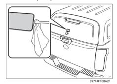
Вставьте ключ для кунга в замочную скважину и поверните его, чтобы открыть кунг.
